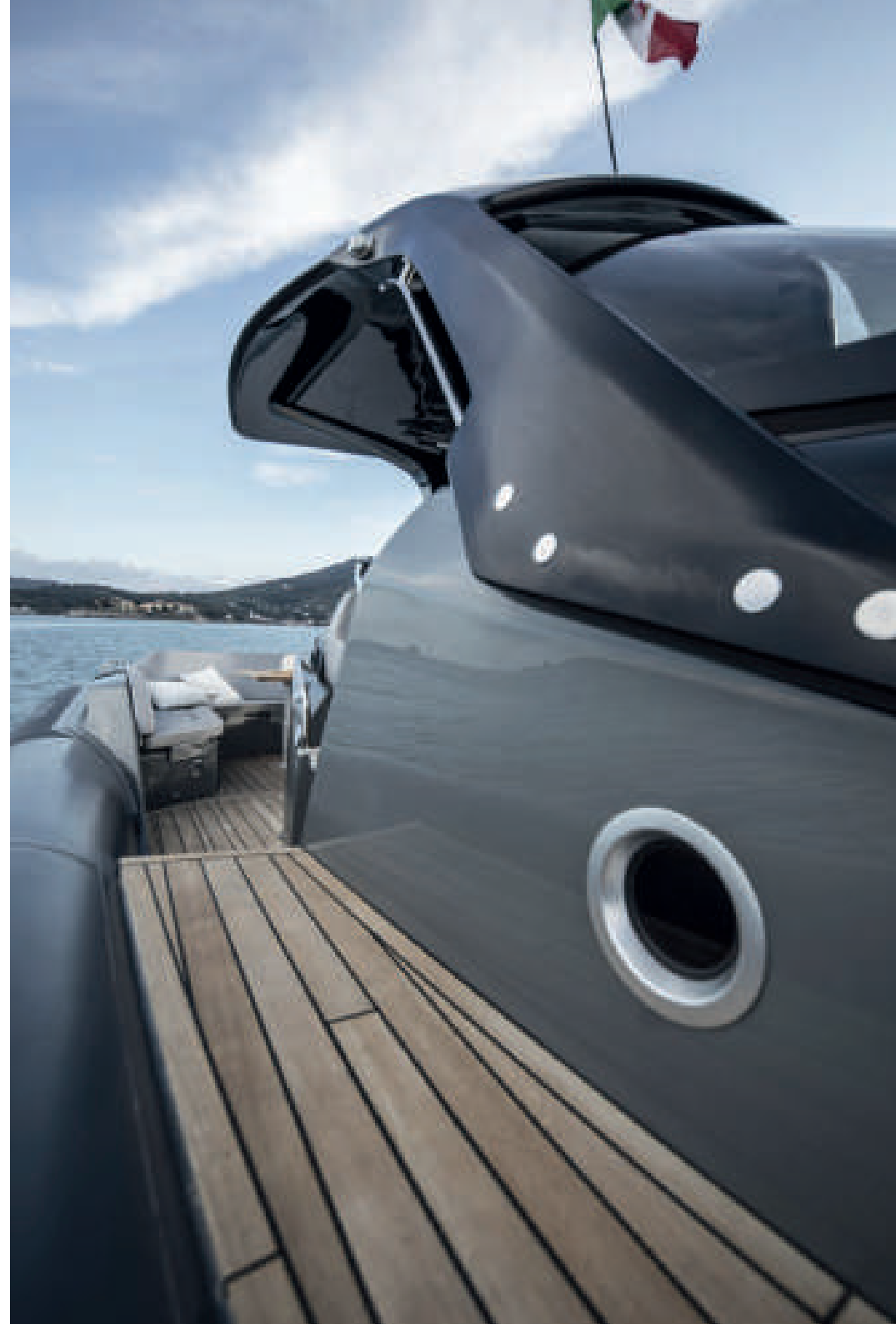
Тиковое покрытие палубы
